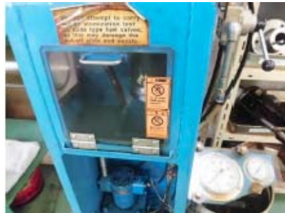
B&W燃料弁の噴射試験風景
