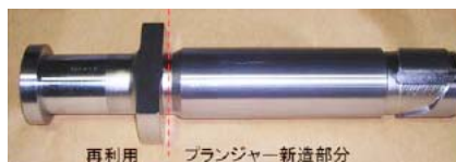
写真2 摩擦圧接により接合されたプランジャー (点線が接合面)
