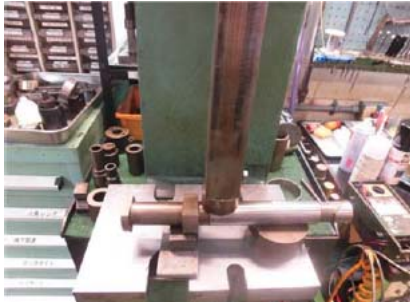
プランジャーの加重曲げ試験の様子
