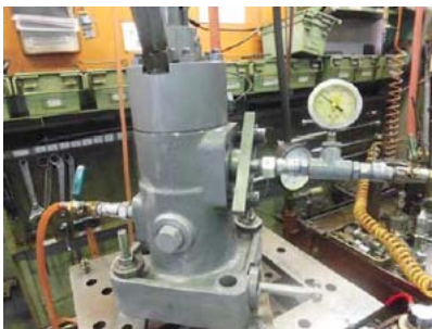
燃料ポンプ復旧後の出荷前試験の様子
