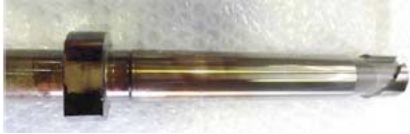
燃料ポンプより抜き出したプランジャー
