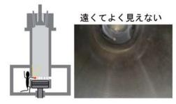
本装置はパノラマカメラと照明で構成され、ピストン頂部に本装置を置いてターニングを行うだけで約10分の1ターニング間に燃焼室内部の全周方向の写真を自動撮影する。本装置を使用することでシリンダカバーを開放することなく低温腐食の兆候等を確認することが可能となり、不具合の早期発見と乗組員の大幅な負荷軽減が可能となった。また装置を設置する際の安全性にも配慮し、掃気ポートに腕を入れずに装置がピストン頂部にセットできるよう専用の治具を作成し本装置のパッケージに加えている。
