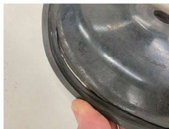
消火液混合装置ダイヤフラムシートの亀裂
