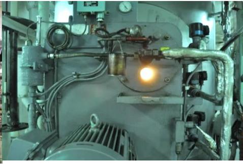
ディーゼル船の補助ボイラー（左；外観、右；燃焼バーナー付近）
