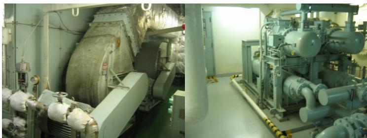
船内居住区空調ユニット（送風機）と空調用冷凍機
