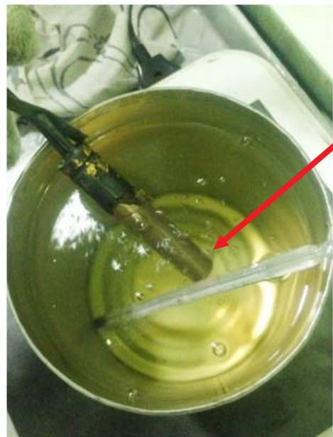
写真－1 感温筒から噴出した気泡
