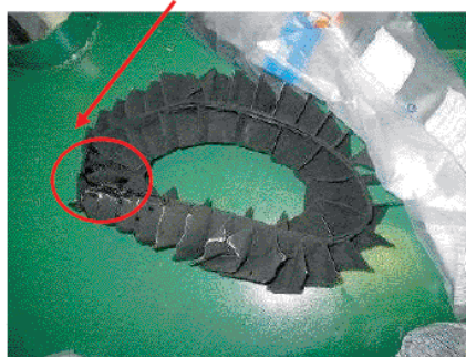
写真2.3-2 二次空気ノズルの曲損状況等
