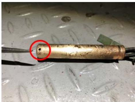
写真－２ 感温筒破孔部 Photo-2 Hole on the Tube
