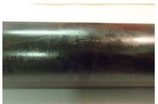
写真－1 Plunger掃除後 かなりのカーボンスラッジが見られた
