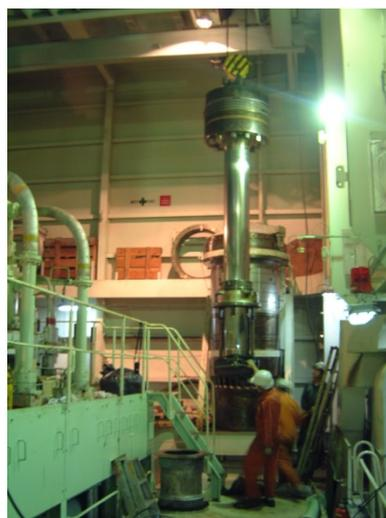
3. 摺動部のピストンリング、シリンダーライナーの掃除、計測、記録（撮影）を行う。
