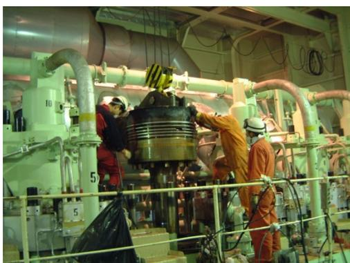
天井クレーンでピストンをシリンダーから抜き出す（ピストン抜き）
